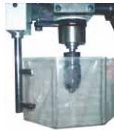
Protector portabrocas con desconexión de máquina a la apertura / Chuck guard with microswitch
